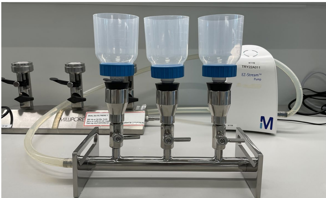
Figur 3. Filtrering av vannprøver. Foto: Marit Måsøy Amundsen.
