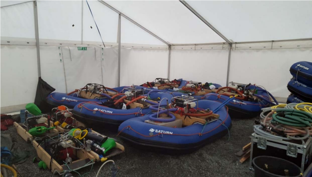
Figur 4. Små raftingflåter brukt i breddedosering og ved dosering av Vektocarb (rotenonslurry). Disse benyttes uten påhengsmotor, og mannskap går i elva ved siden av flåta. Lav vekt, god stabilitet og lite dyptgående gjør disse flåtene svært egnet på elva. Foto: Dag. H. Karlsen
