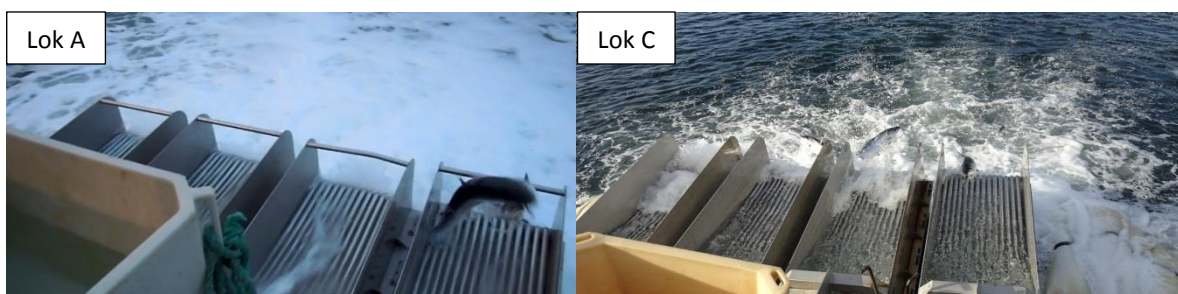
Figur 3. Uttakspunkt «etter»: Avsiler FLS-avluser. Tilfeldig utvalgte fisker ble håvet direkte over i et bedøvelseskar før velferdsregistrering. Bildet fra lokalitet A viser at avsilerne hadde en øvre stang ved enden som flere fisker traff. Stangen ble fjernet i testløpet, se bilde lokalitet C, og her vises også deler av filterposen til oppsamling av lus som ligger i vannet helt til høyre. Foto: K. Gismervik
