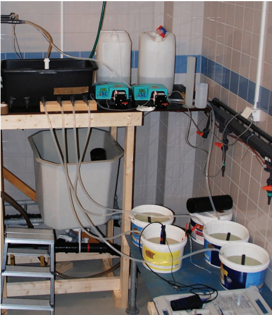
Figur 4: Forsøksoppsett som viser doseringspumper (lysegrønne), kanner (25l) for Al- og svovelsyrestamløsninger, innblandingskar for vann tilsatt kjemikalier (sort kar), og bøtter for Al-eksponering av laks infisert med G. salaris .
