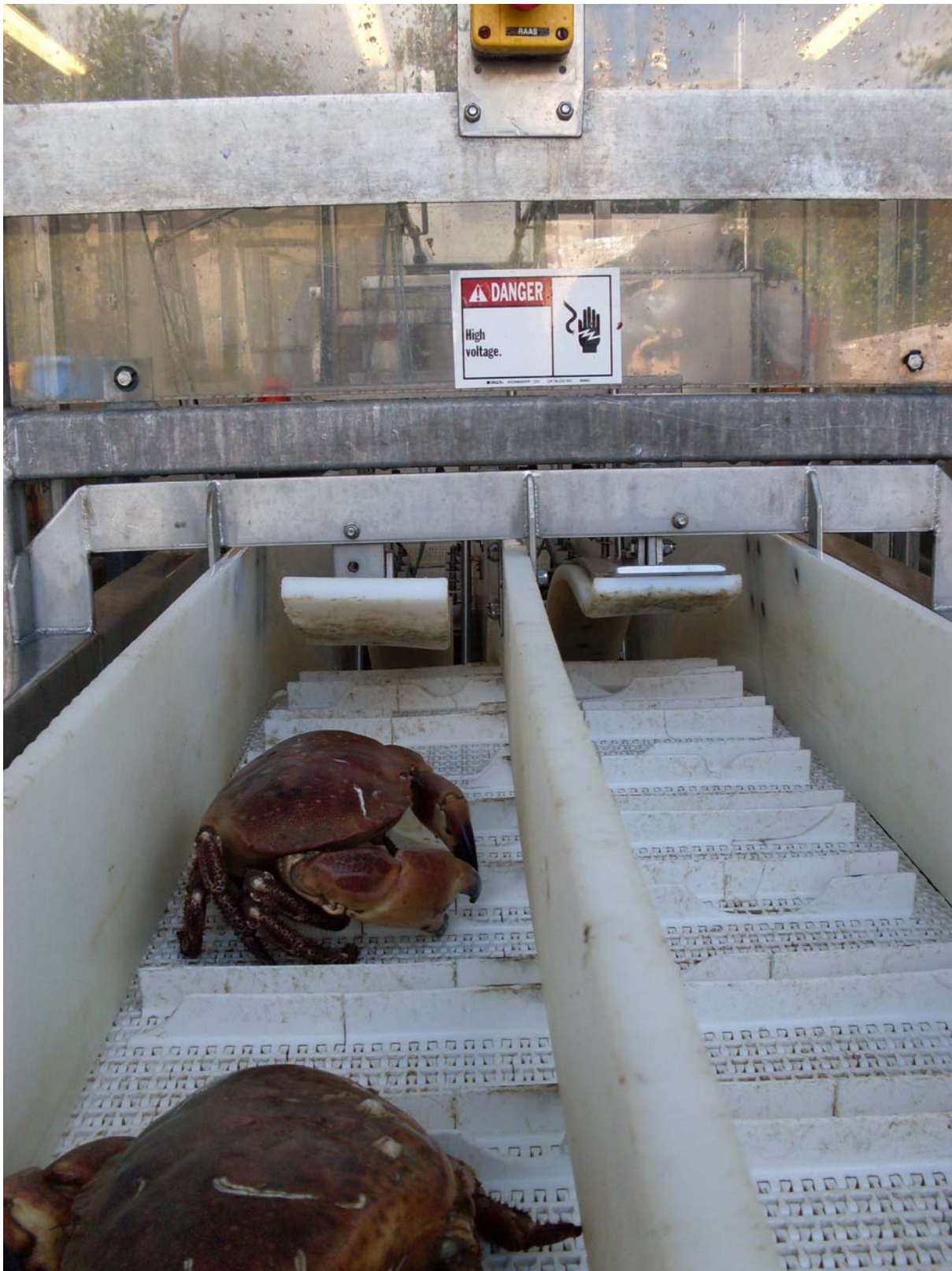
Figur 2. Samlebåndet i Crustastun multipelbedøver. Foto: Inger Helen Stenevik.
